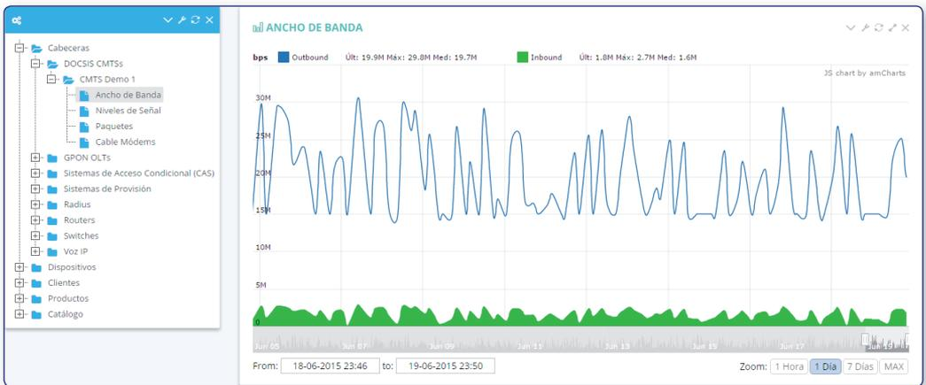
**Observer** es capaz de monitorizar cualquier dispositivo conectado a la red a través de **SNMP**.
